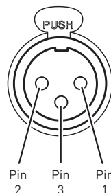
Conector de entrada balanceada (XLR hembra)
