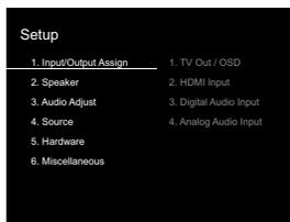
7. С помощью курсорных кнопок выберите «6. Miscellaneous» — «Firmware Update» — «Update via USB» (Прочее — Обновление ПО — Обновление по USB), затем нажмите кнопку ENTER.
