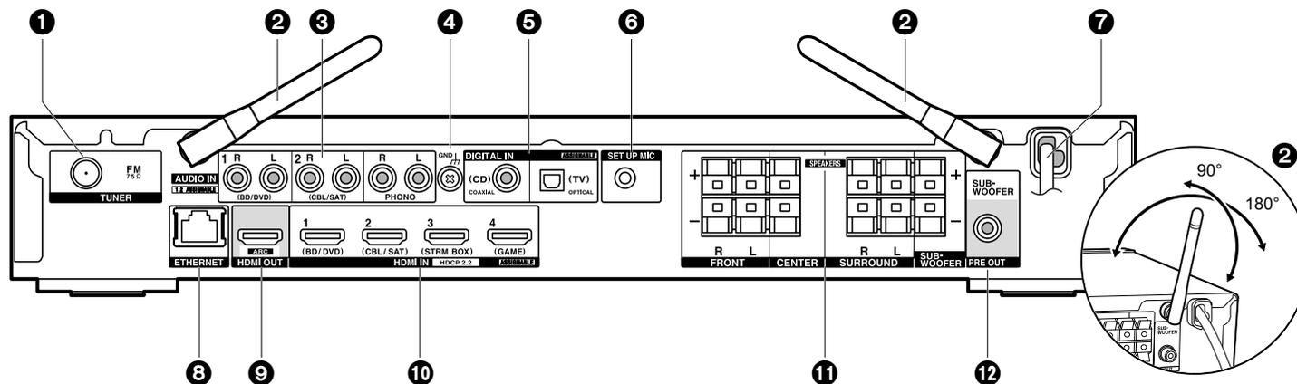
1. Разъем TUNER FM 75Ω: Используется для подключения входящей в комплект антенны.
