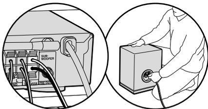
Убедитесь, что надежно закрепили колоночные кабели, так чтобы они не выпадали из разъемов после подключения. Если провода коснутся задней панели устройства или провода + и – коснутся друг друга, сработает схема защиты и питание будет отключено (➔ Стр. 68).
