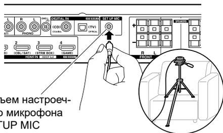
Разъем настроечного микрофона SETUP MIC
