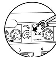
Если проигрыватель оснащен проводом заземления, то подключите его к разъему GND.
