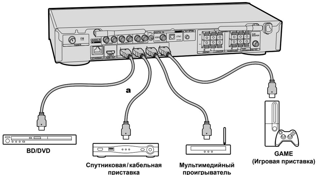
Далее представлен пример подключения аудио/видео компонентов, оснащенных HDMI разъемом. При выполнении подключения аудио/видео компонентов, соответствующих стандарту CEC (Consumer Electronics Control), вы сможете воспользоваться такими функциями как HDMI CEC и HDMI Standby Through, которые позволят вам воспроизвести видео и аудио сигнал AV компонентов на телевизоре при переключении самого компонента в режим ожидания. (→ Стр. 75)
