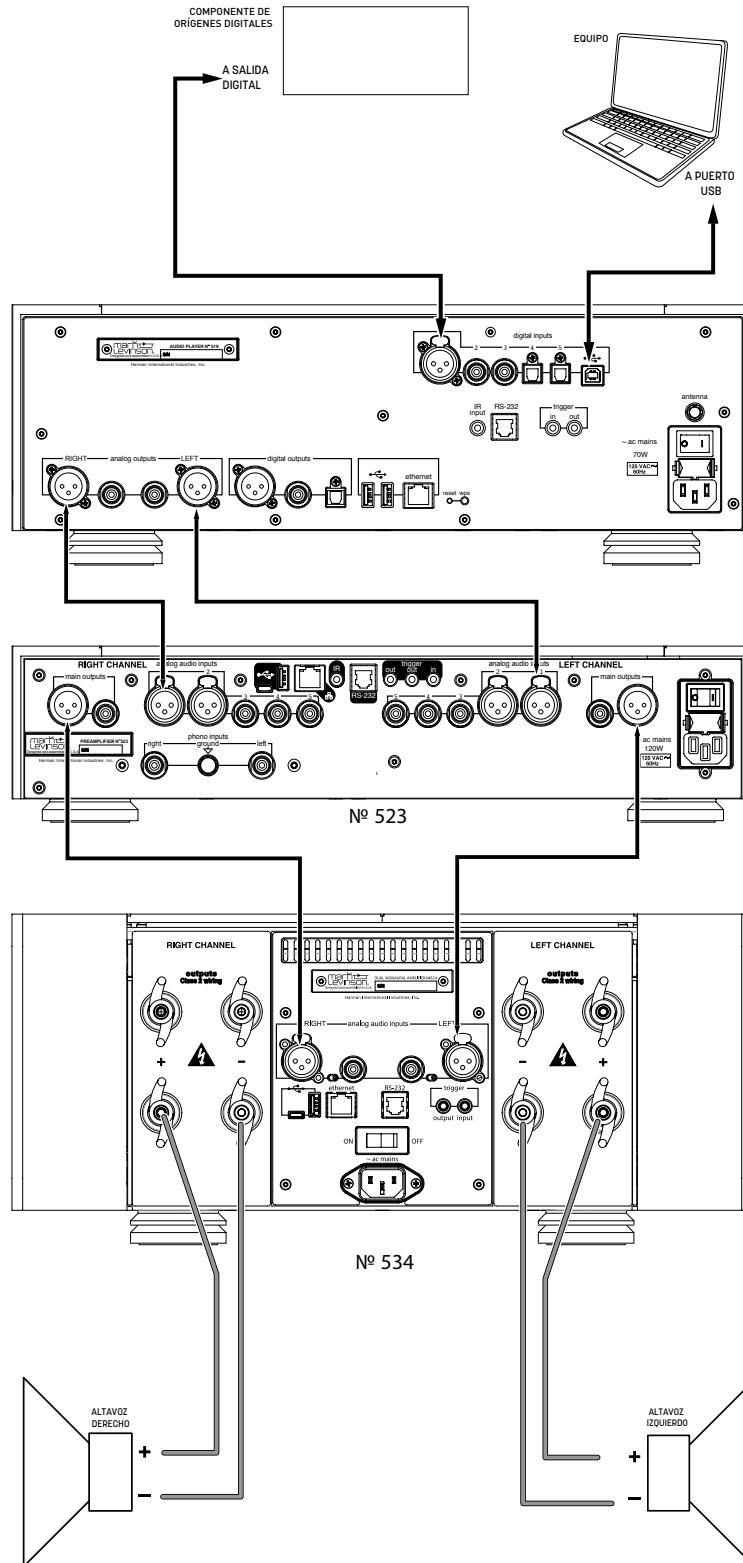
Nº 519 conectado a un preamplificador usando las salidas digitales
