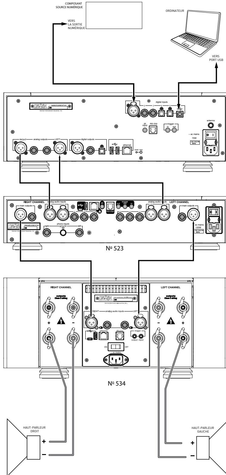
N° 519 connecté à un préamplificateur utilisant les sorties numériques
