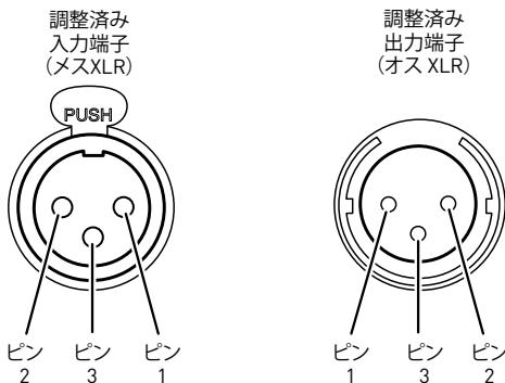
**デジタル出力端子:**Nº 519には3つのデジタル出力端子があります。AES/EBU調整済みXLR、同軸S/PDIF RCA、オプティカルS/PDIF TOSLINKです。各デジタル出力は、DAC、またはDACが内蔵されているプリアンプへの2チャンネルデジタル接続を提供します。Mark Levinsonは、プレーヤーが接続されているDACまたはプリアンプで接続が利用できる場合、なるべく最適な音質を確保するために調整済みデジタル出力を使用なさるようお勧めしています。
